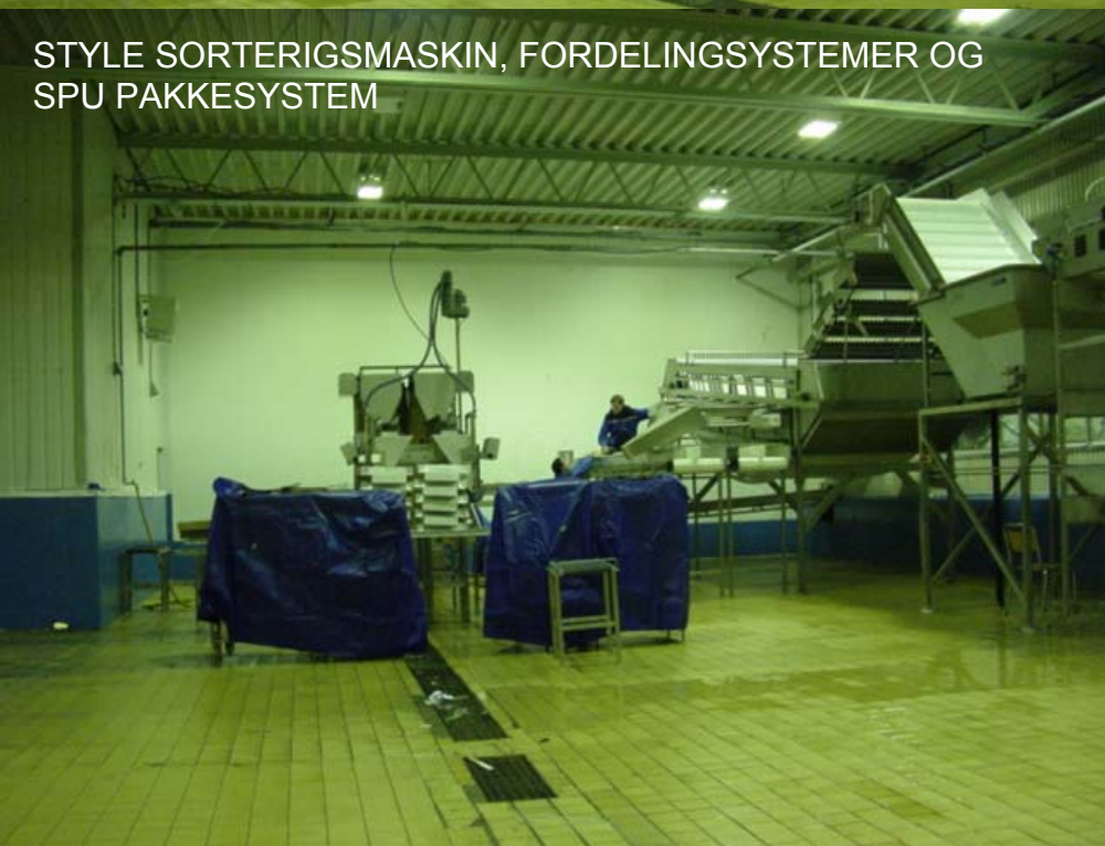
SPU PAKKESYSTEM, DOBBELT MED 14 SLIPP I MIN. PAKKING I POSER. RULLEBANER FOR BUNN OG LOKK.
