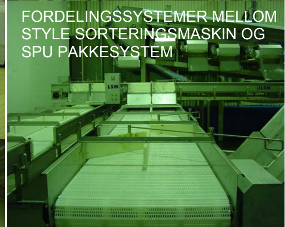
INNMATING TIL STYLE MASKIN KAPASITET; SILD: 50 TONN I TIMEN LODDE: 26 TONN I TIMEN
